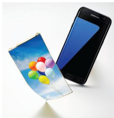
Figura 1.9- Ecrã de telemóvel baseado num OLED flexível, sendo capaz de desligar/ligar os seus pixéis 3x mais rápido que os dispositivos comuns, o que, permite a exibição mais fluída de imagens/vídeos (tempo de resposta rápido)
