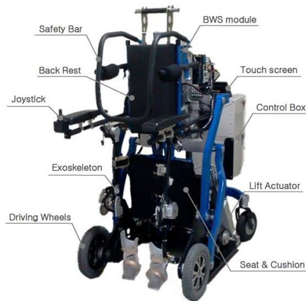
Figura 2.4 - Sistema de reabilitação de membros inferiores com cadeira de rodas [4]
