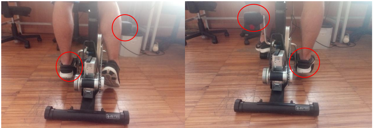
Figura 4.24 - À esquerda o paciente coloca todo o seu peso sobre o pedal esquerdo e à direita sobre o pedal direito
