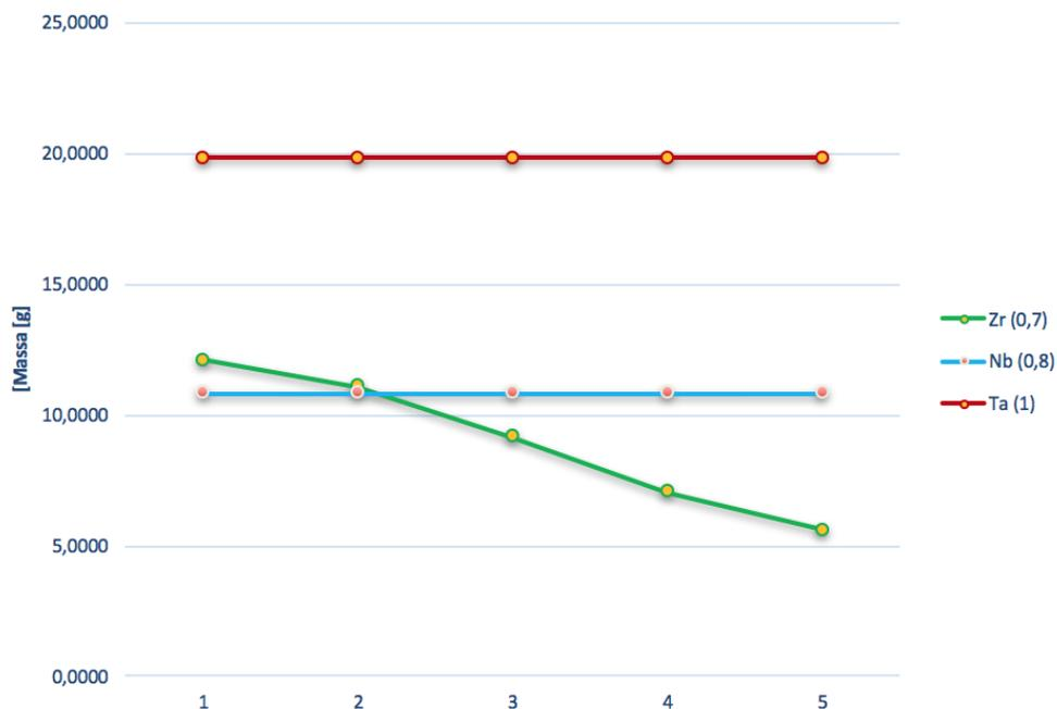
Figura 4.52 - Perda de massa nas amostras de maior energia adicionada mergulhadas mistura ácida 1
