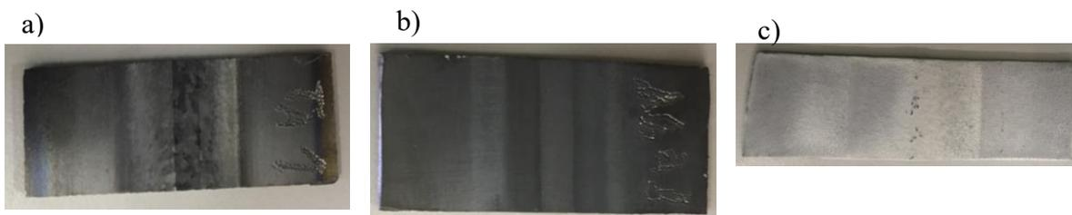
**Figura 4.53 - Materiais de maior energia adicionada após corrosão: a) Tântalo 1 kJ/mm; Nióbio 0,8 kJ/mm; c) Zircónio 0,7 kJ/mm**
