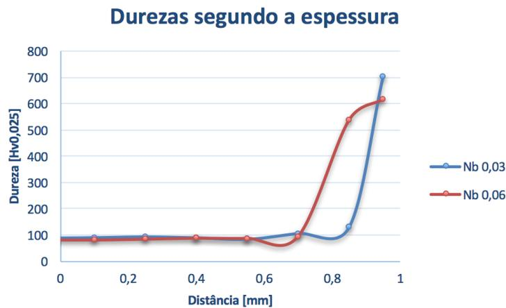
Figura 4.38 - Durezas segundo a espessura das soldaduras laser
