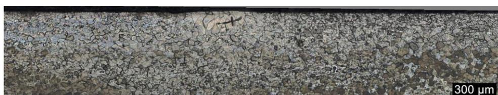
**Figura 4.8 - Macrografia níbio (LASER, E=0,03 kJ/mm)**
