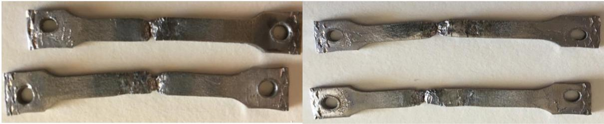
Figura 4.43 - Fratura do tântalo: a)  $E=1$  kJ/mm; b)  $E=0,4$  kJ/mm
