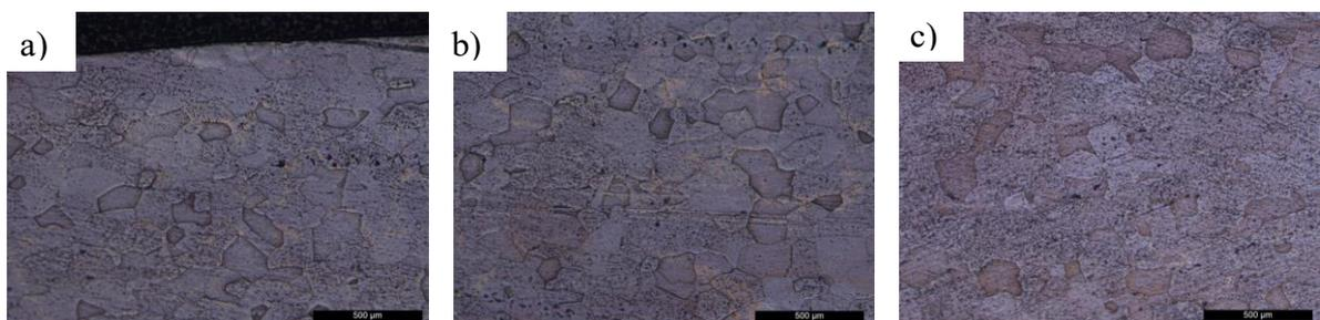
**Figura 4.21 - Microestrutura tântalo, soldadura laser ( $E=0,015$  kJ/mm): a) Zona Fundida; b) Zona afetada pelo calor; c) Metal base**
