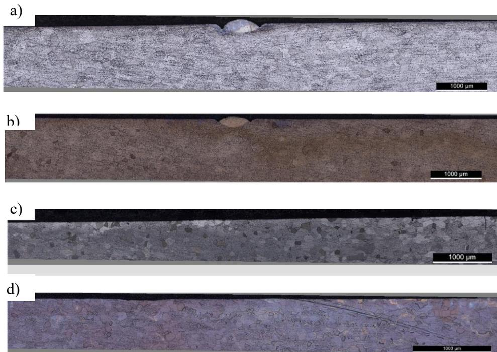
Figura 4.4 - Micrografia do tântalo soldado a laser: a)  $E=0,12$  kJ/mm; b)  $E=0,06$  kJ/mm; c)  $E=0,03$  kJ/mm; d)  $E= 0,015$  kJ/mm
