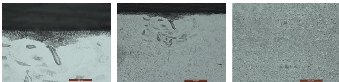
**Figura 4.32 - Microestrutura zircônio, soldadura Laser (0,0015 kJ/mm): a) Zona de fusão (200x); b) Zona afetada pelo calor (100x); c) Metal Base (200x)**
