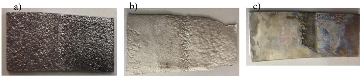
**Figura 4.55 - Materiais de menor energia adicionada após corrosão: a) Tântalo 0,4 kJ/mm; b) Nióbio 0,3 kJ/mm; c) Zircónio 0,3 kJ/mm**
