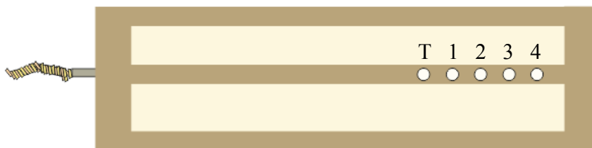
Figura 4.26 Configuração base do cartucho 1 e 4- Fibras de Sílica, 2 e 3 -Fibras de PMMA, T-Trigger
