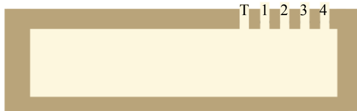
Figura 4.27 Cartucho vista de lado, aberturas para inserir as fibras 1 e 4- Fibras de Sílica, 2 e 3 -Fibras de PMMA, T-Trigger
