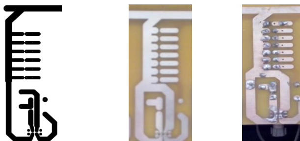
Figura 3.22 Circuito de fase negativa
