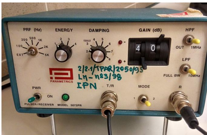
Figura 3.8: Gerador de pulsos emissor-recetor
