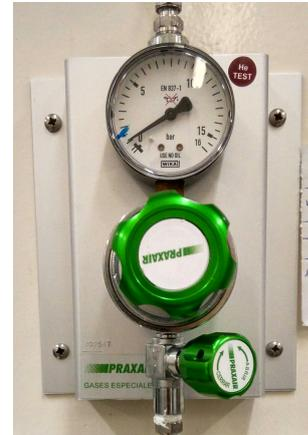
Figura 3.22: Azoto usado na limpeza da célula
