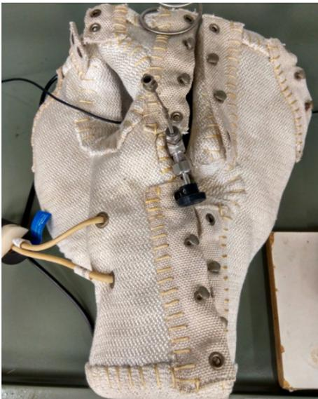
Figura 3.13: Luva de isolamento térmico
