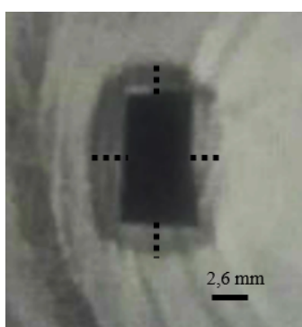
Figura 3.21: Halo de inibição criado em redor do filme Zn6 sobre esfregaços de S.aureus após 38 horas de contacto no escuro.
