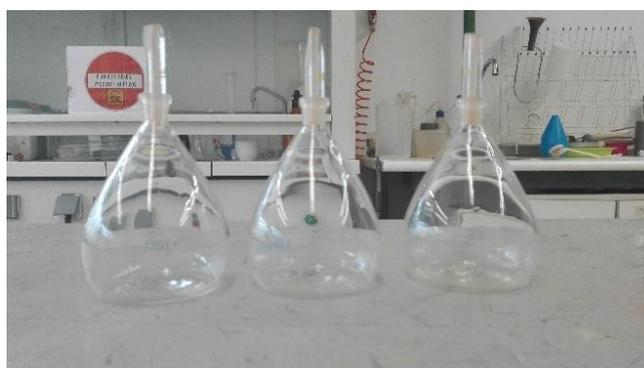
**Figura 12 - Picnómetros utilizados**
