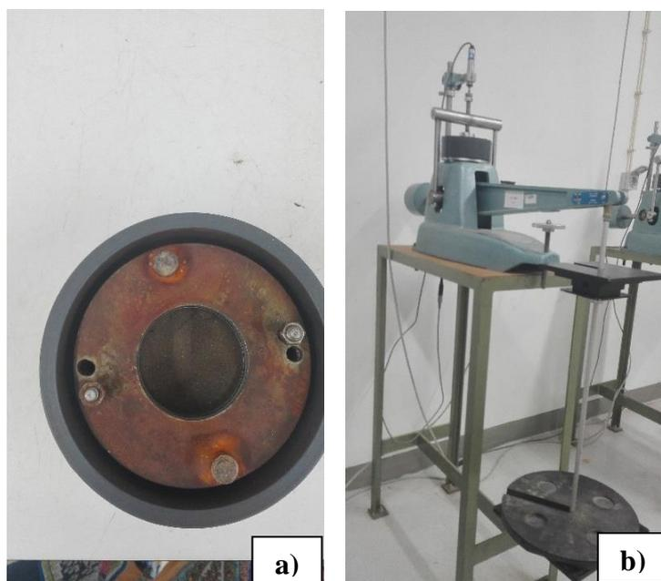
Figura 16 - Edométrico do Laboratório de Geotecnia do DEC-FCTUC
