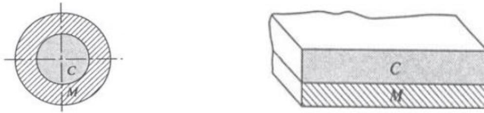
**Figura 1.9** a) Configuração simétrica em forma esférica, b) Configuração assimétrica em forma de sandwich de face aberta
