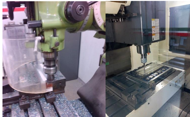
Figura 3.4. Operações de fresagem (convencional e CNC) utilizadas na obtenção dos provetes.
