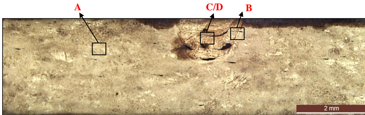
Figura 4.4. Macrografia da secção longitudinal da série P20_PM2.
