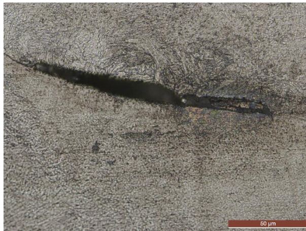
Figura 2.5. Falta de fusão no aço temperado AISI H13 (resultado obtido da presente tese).
