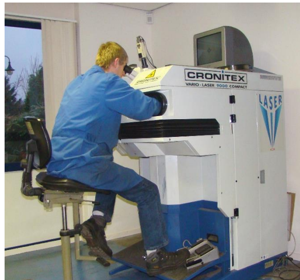
Figura 3.2. Máquina de soldadura a laser Nd:YAG( adaptado de www.begado.nl ).
