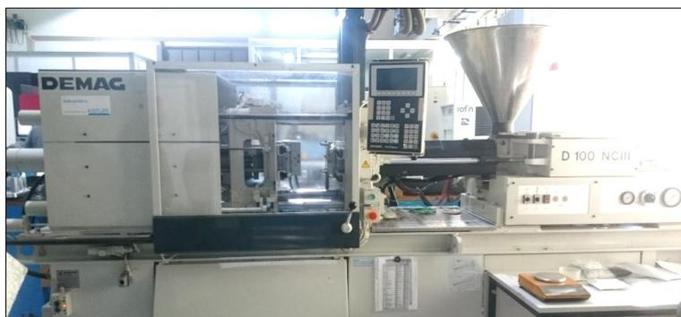
Figura 2.6 – Equipamento *DEMAG D100 NCIII* utilizado para injeção de provetes P2.
