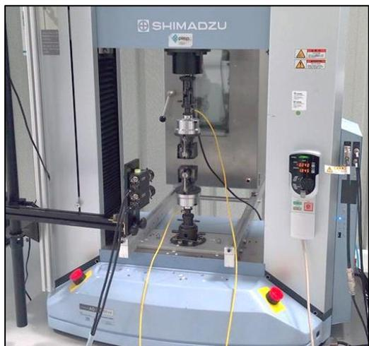
Figura 2.11 – Equipamento usado para ensaios de tração no PIEP
