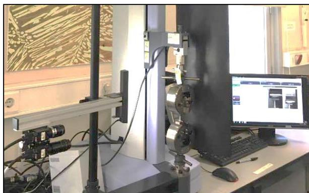
Figura 2.12 – Equipamento usado para ensaios de tração na FEUP (Shimadzu).
