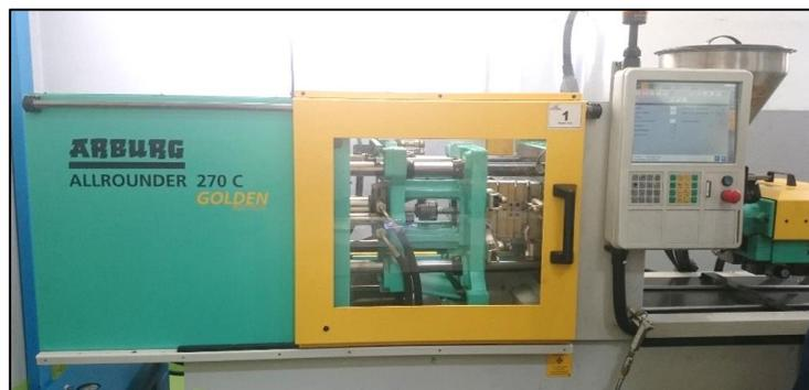
Figura 2.7 – Equipamento *ARBURG ALLROUNDER 270C GOLDEN* usado para injeção de provetes P3.
