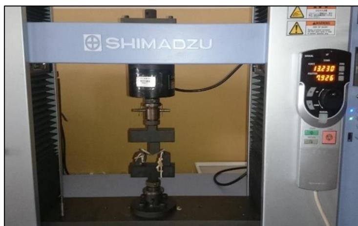
Figura 2.14 – *Shimadzu* – Equipamento usado para ensaios de flexão no DEM/FCTUC.
