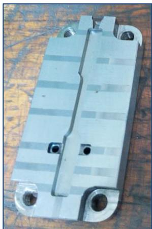
Figura 2.8 – Zona moldante de provetes de tração
