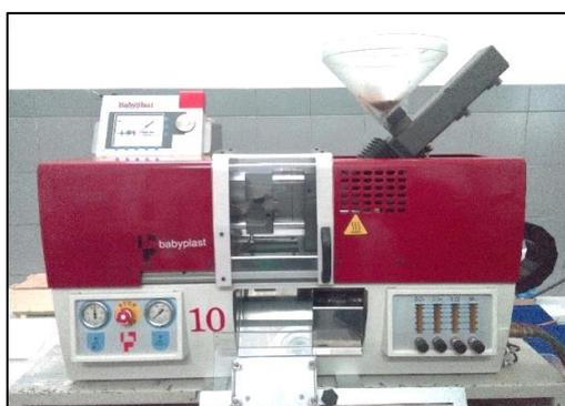
Figura 2.5 – Equipamento *Babyplast* utilizado para a injeção de provetes P1.
