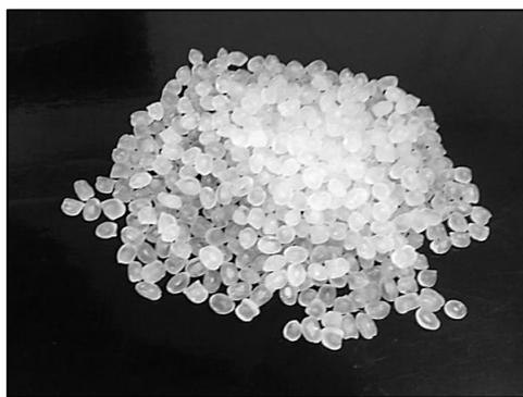
Figura 2.2 – PP usado na produção dos nanocompósitos (REPSOL ISPLEN<sup>®</sup> PP099K2M).
