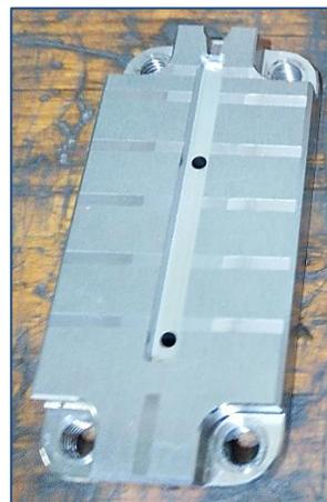
Figura 2.9 – Zona moldante de provetes de flexão
