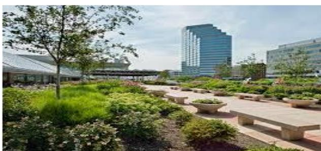
Figura 2.6 - Exemplo de uma cobertura Intensiva (Fonte: <http://www.greenroofs.com>)
