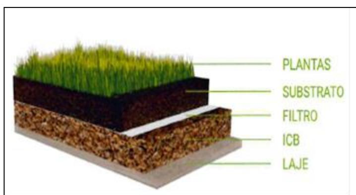
Figura 2.19 - Esquema de construção de um modelo Sistema de Cobertura Verde Estruturado em Aglomerado de Cortiça Expandida ( Fonte: <http://www.itecons.pt>)
