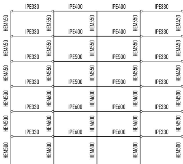
Figura 4.18- Solução final do pórtico na direção y do edifício de 6 pisos, caso de estudo 2
