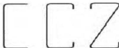
Figura 2.2- Secções transversais dos perfis estruturais de LSF (adaptado de Soares et al. , 2017).
