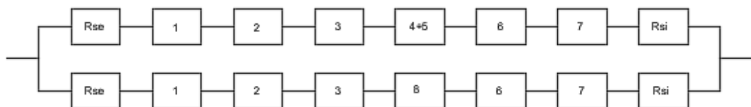
Figura 3.4- Método de cálculo do R_{max} (adaptado Doran e Gorgolewski, 2002).
