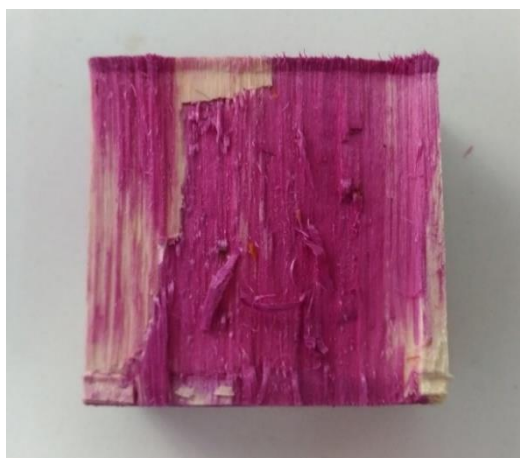
Figura 4.13 – Provete de resistência ao corte pela linha de cola de elemento colado com MUF, ao qual foi aplicada solução
