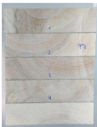
Figura 4.3 - Orientação das lamelas em classe de serviço 3
