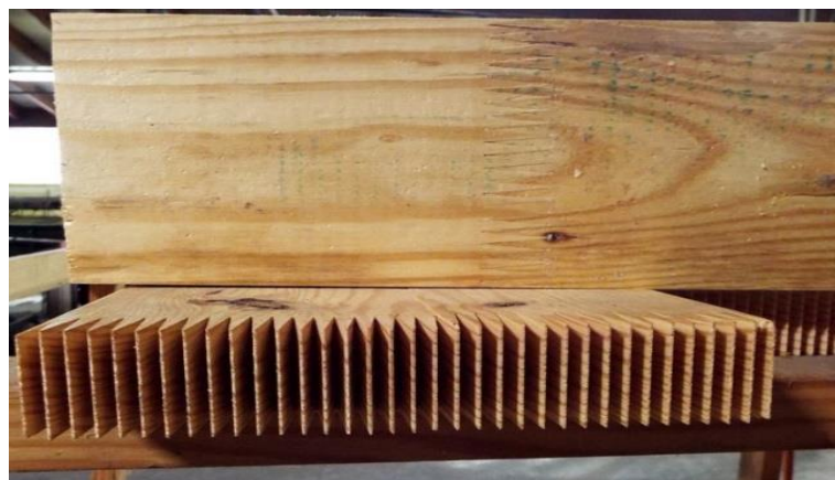
Figura 2.5 – Finger joints/ligações de topo por entalhes múltiplos ( https://www.pinterest.pt/writemealya/glulamwood/ )
