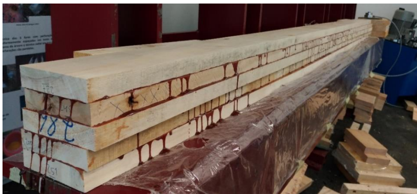
Figura 4.4 - Viga após colagem com PRF
