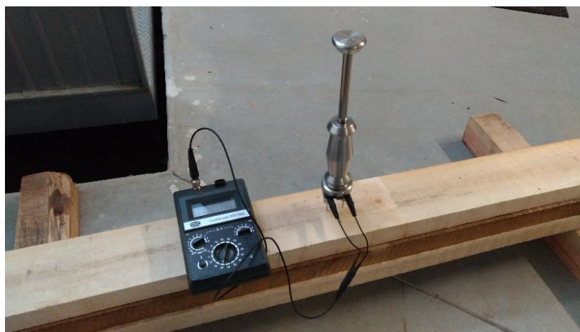
Figura 4.1 – Medição do teor de água com recurso a humidímetro de agulhas
