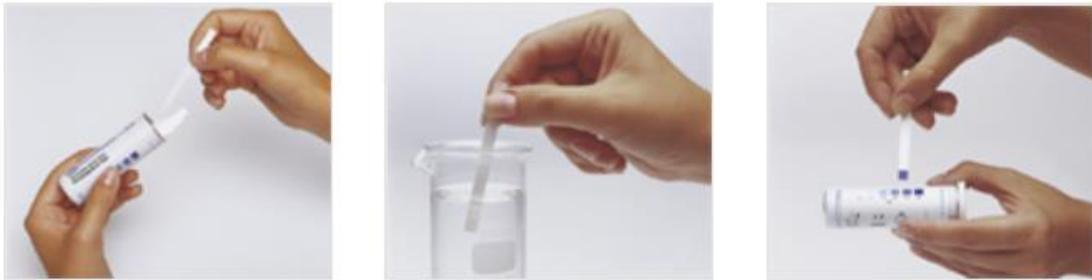
**Figura B.1-** Exemplificação da medição da  $[\text{H}_2\text{O}_2]$  com testes rápidos.
