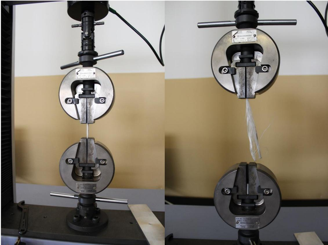
**Figura2.6:** Início e fim de um ensaio de tração.
