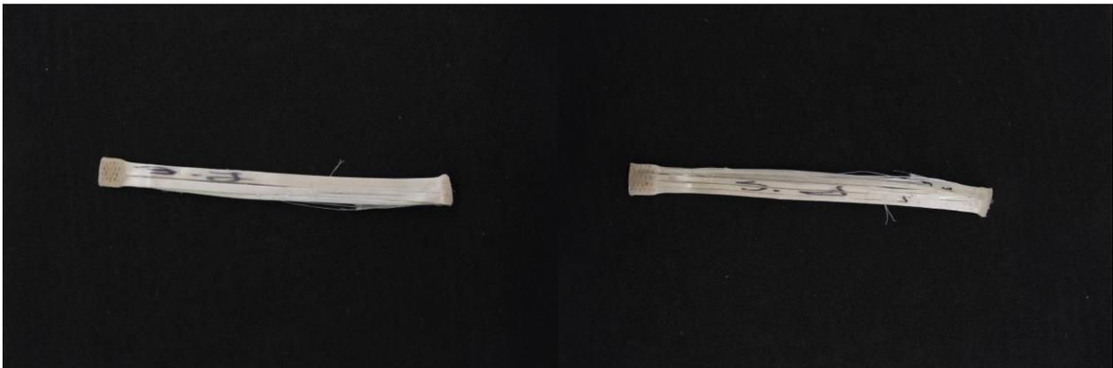
**Figura A. 11:** Provete 3.J após tração.
