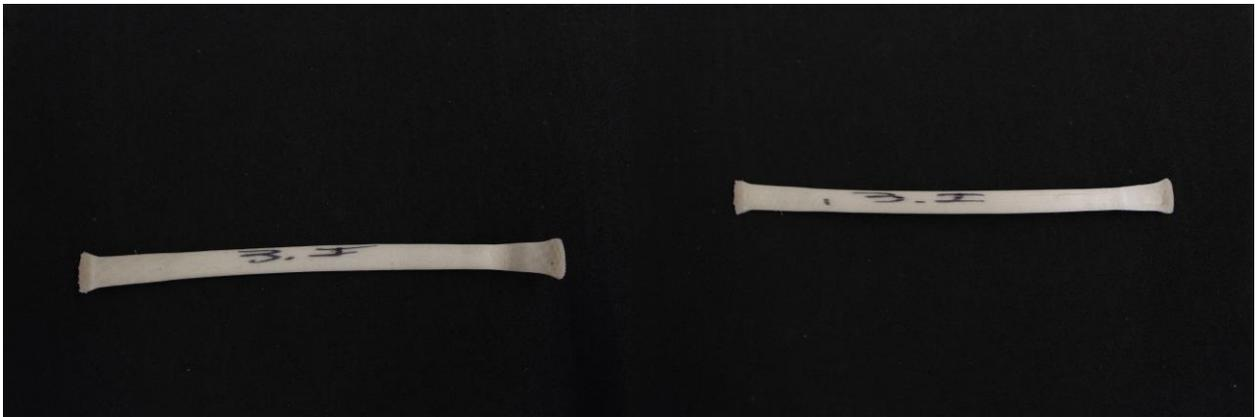
**Figura A. 10:** Provete 3.I após tração.
