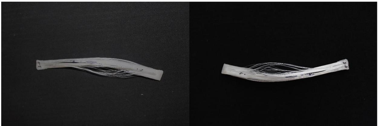
**Figura A.2.:** Provete 1.K após tração.
