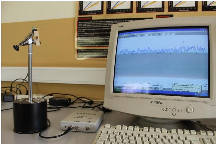
**Figura2.5:** Montagem para o teste por Impulso (da direita para a esquerda, suporte do provete, osciloscópio e o computador com software).
