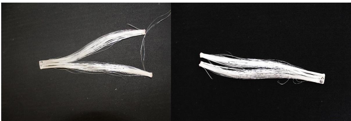
**Figura A. 5:** Provete 2.B após tração.
