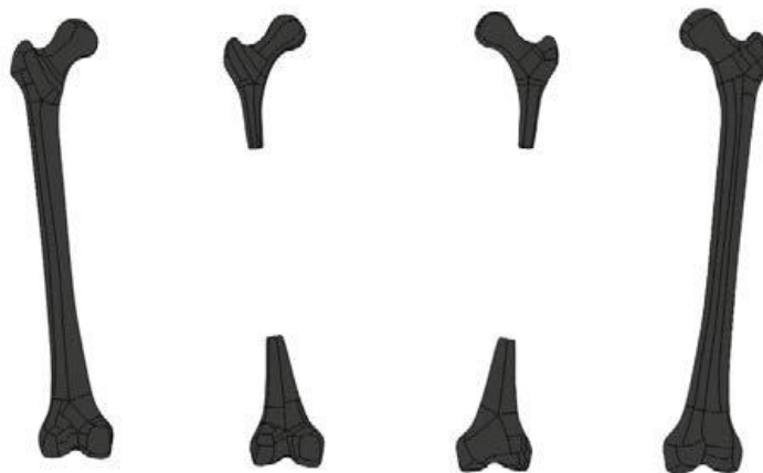
Figura 3.1. Partes trabecular e cortical do modelo CAD do fémur [1]
