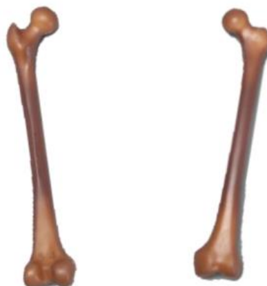
Figura 3.2. Modelo físico do fémur (Sawbones) [8]
