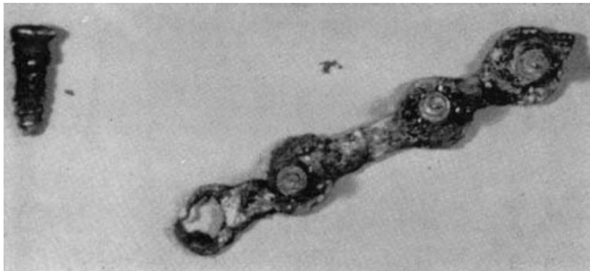
Figura 2.7. Placa de Lane abandonada devido à corrosão [15].
