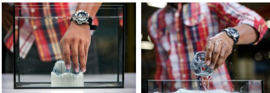
Figura 1.7. Utilização de suportes com capacidade para se dissolver [21]
