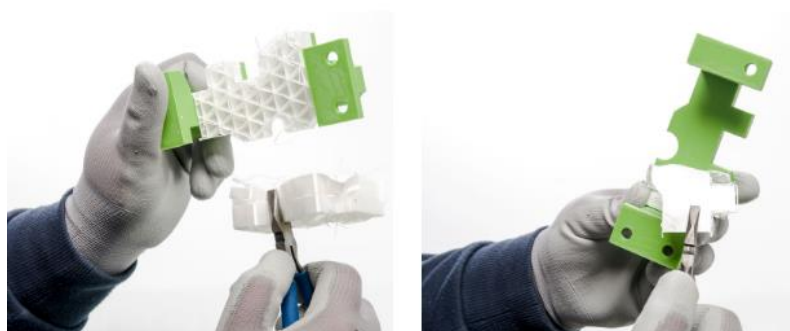
Figura 1.6. Utilização de suportes gerais [21]
