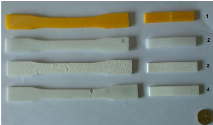
Figura A.1. Provets tração e flexão produzidos em 1.PLA; 2.POM; 3.PA12,FDM; 4.PA12,SLS
