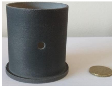
Figura 3.19. Peça 4 depois de sofrer jateamento abrasivo
