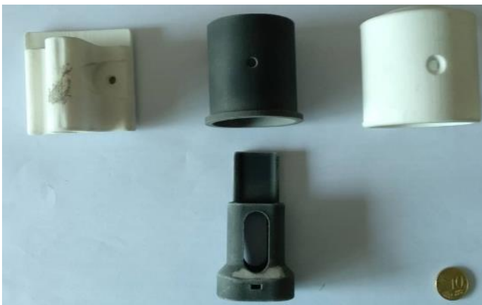
Figura A.5. Peças construídas em PA12 pelo processo SLS
