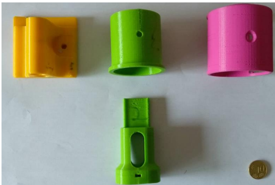
Figura A.2. Peças construídas em PLA pelo processo FDM
