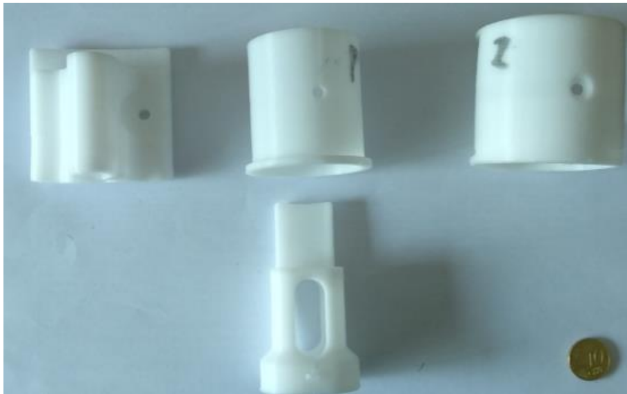
Figura A.3. Peças construídas em POM pelo processo FDM
