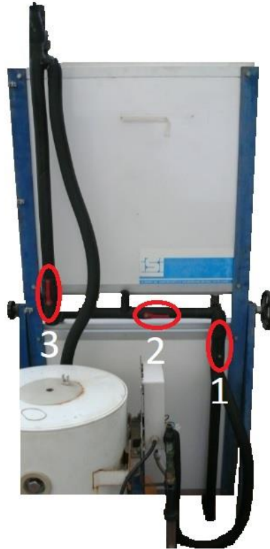
Figura 4.2. Ligação em série ou em paralelo dos coletores.
