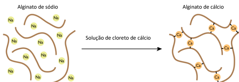
Figura 48 – Esquematização do processo de reticulação do alginato de sódio com cloreto de cálcio, agente reticulante 233 .
