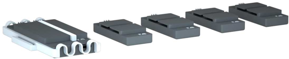
Figura 111 - Representação de proposta de design dos módulos e sistema de encaixe em 3D.
