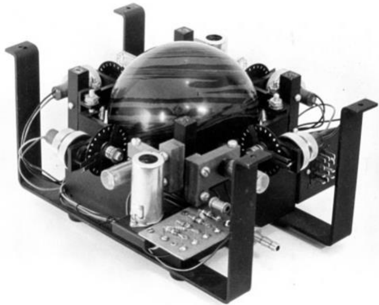
Figura 2 - Um dos primeiros protótipos da trackball (Smith, 2017).
