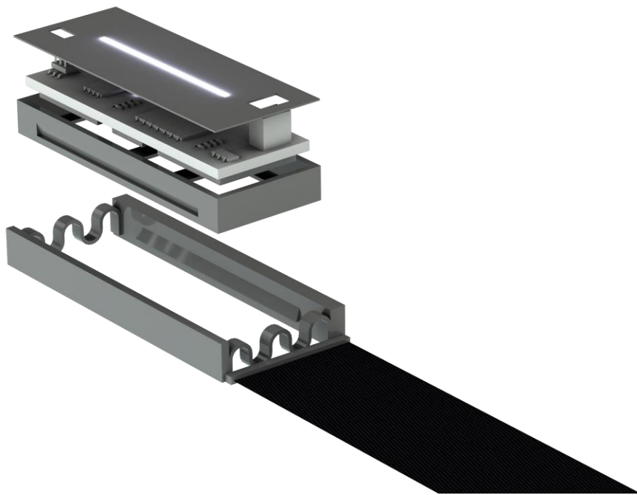
Figura 102 - Render de proposta do design do dispositivo e respetivo sistema de encaixe.
