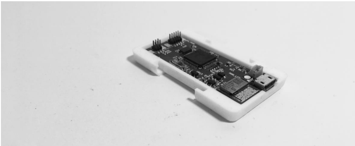
Figura 44 - Teste de compatibilidade das dimensões da placa eletrônica principal, no respectivo módulo.
