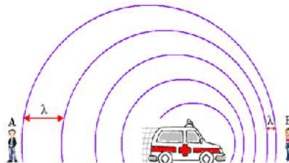
Figura 7 – A fonte sonora afasta-se do observador A (maior comprimento de onda, menor frequência) e aproxima-se do observador B (menor comprimento de onda, maior frequência).
