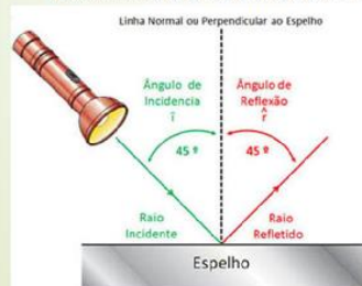
Figura 1 – Reflexão regular da luz (modelo de raios luminosos).
