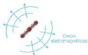
Figura 4 – Cargas elétricas em oscilação produzem ondas eletromagnéticas.
