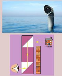
Figura 3 - Periscópio e esquema do funcionamento básico.
