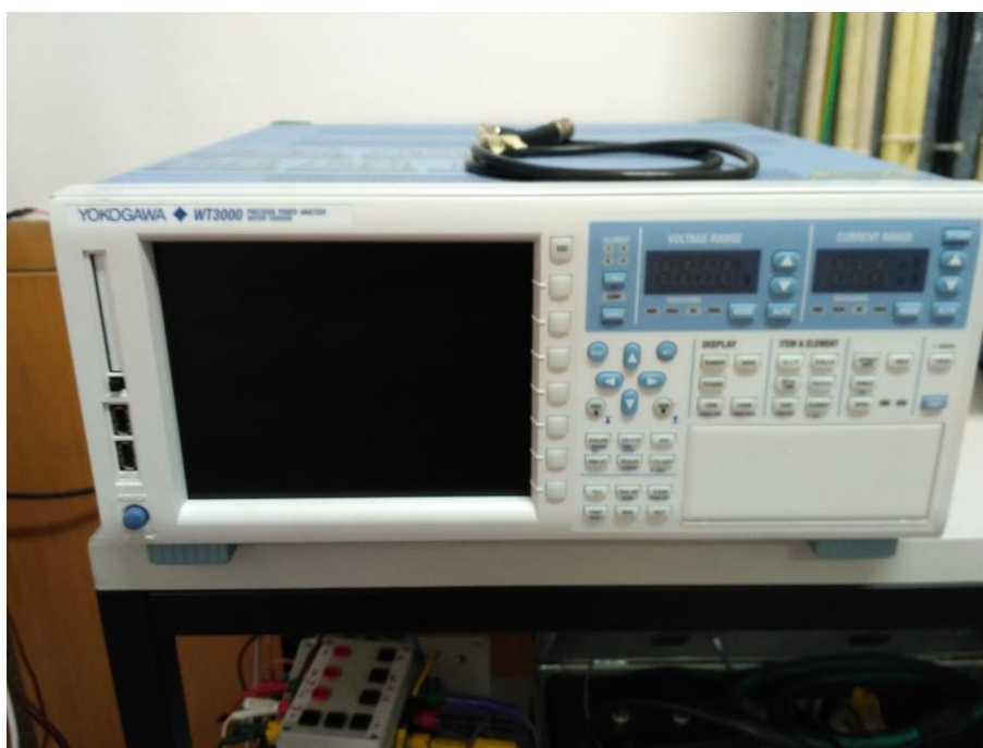
Figura A.1: Analisador de potência YOKOGAWA WT3000
