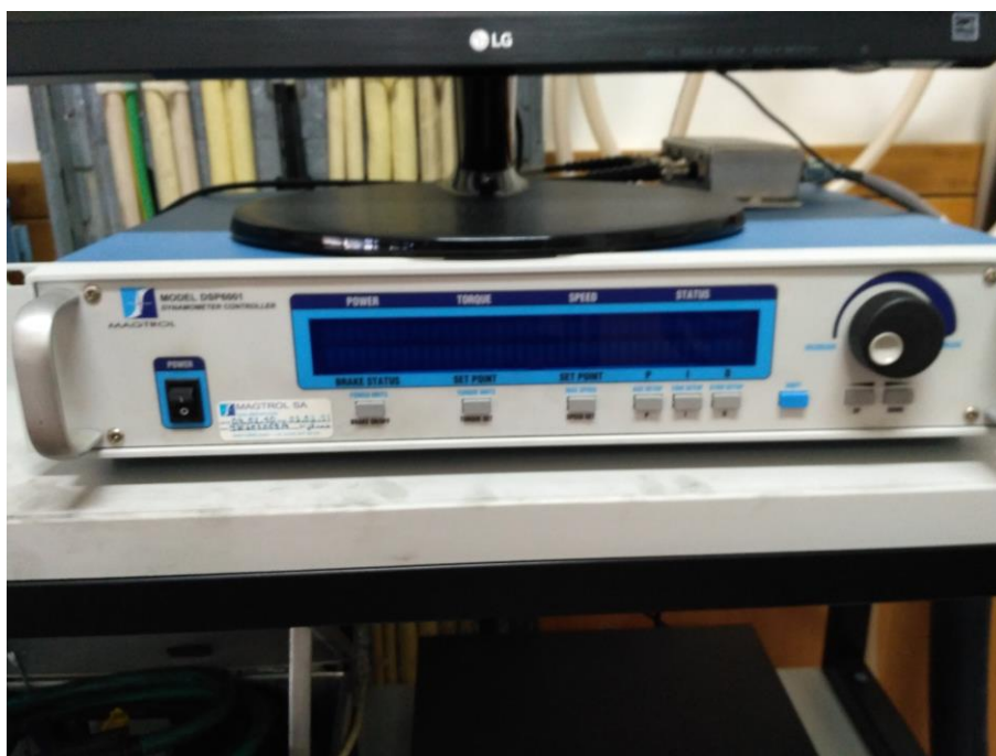
Figura A.2: Controlador do dinamômetro MAGTROL DSP6001
