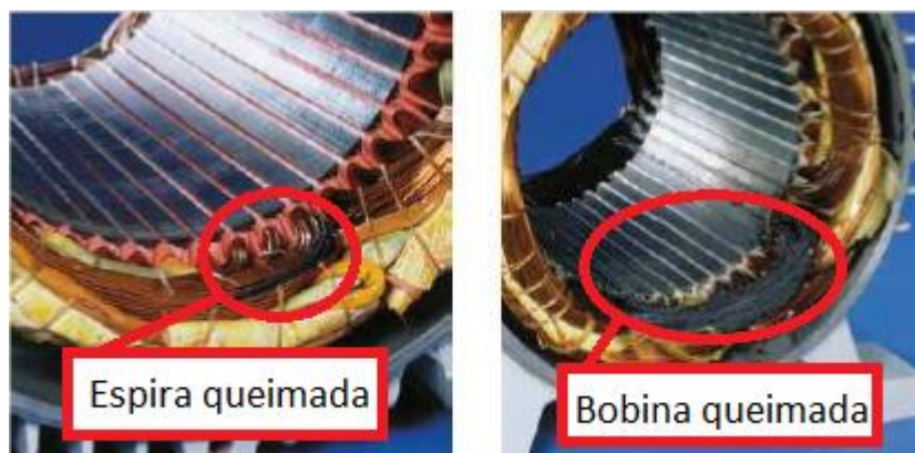
Figura 2.7: A imagem do lado esquerdo representa um curto-circuito de espiras que poderá levar à imagem do lado direito que representa um curto-circuito de uma bobina
