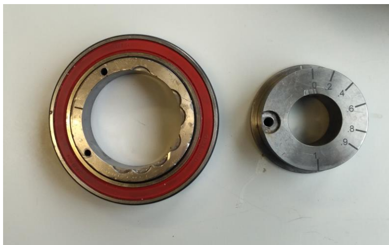
Figura 5.8: Mecanismo que impõe excentricidade dinâmica e rolamento
