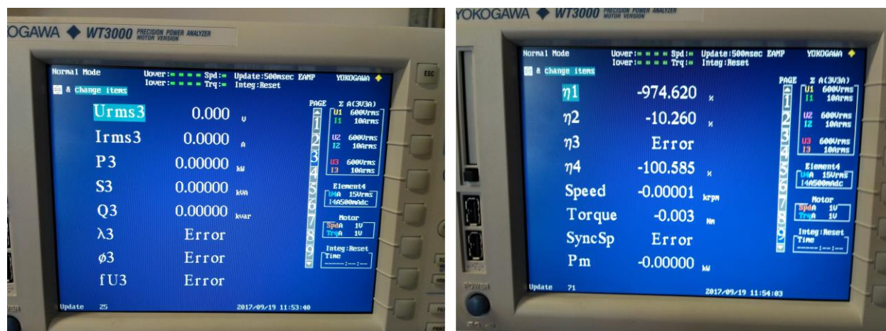
Figura 6.2: Exemplo das grandezas apresentadas no analisador de potência
