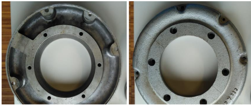
Figura 5.5: Tampa do lado do ventilador, do lado esquerdo a parte interior e do lado direito a parte exterior
