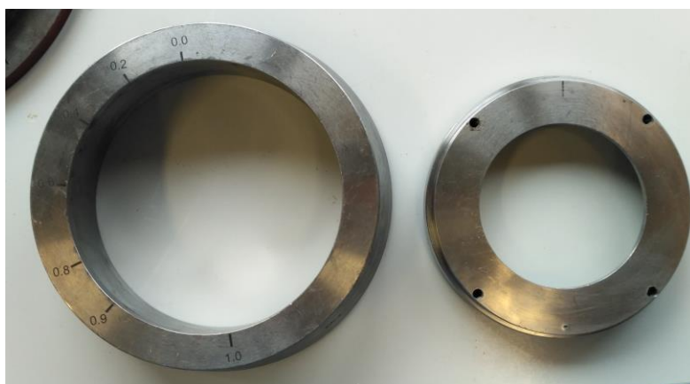
Figura 5.7: Mecanismo que impõe excentricidade estática
