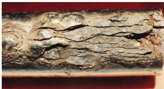
Figura 2.9 – Exemplo ilustrativo de corrosão por camadas
