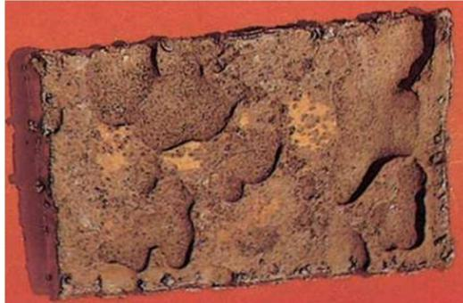
Figura 2.4 – Exemplo ilustrativo de corrosão – fricção
