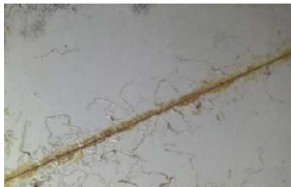
Figura 2.8 – Exemplo ilustrativo de corrosão filiforme
