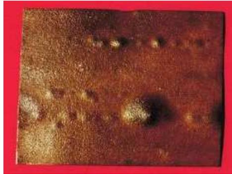
Figura 2.12 – Exemplo ilustrativo de corrosão por fragilização pelo hidrogénio
