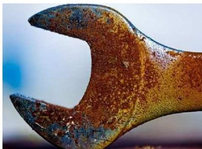
Figura 2.3 – Exemplo ilustrativo de corrosão uniforme
