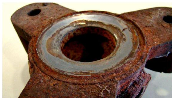
Figura 2.15 – Exemplo ilustrativo da corrosão – erosão
