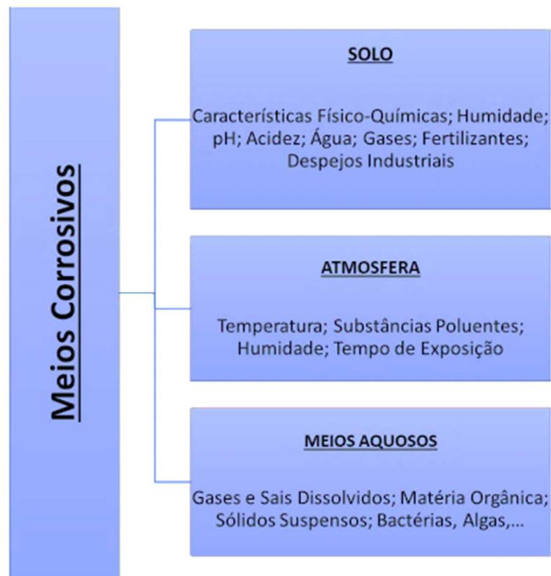
Figura 2.18 – Diagrama esquemático dos principais meios corrosivos [12, 13, 24]
