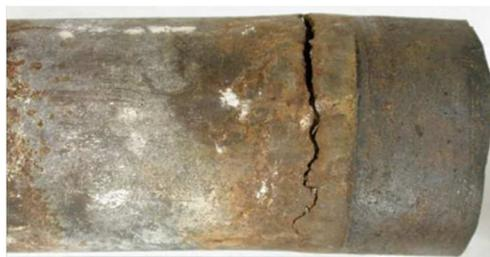
Figura 2.17 – Exemplo ilustrativo de corrosão sob fadiga
