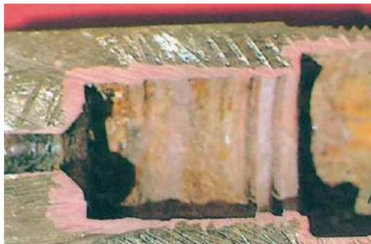
Figura 2.11 – Exemplo ilustrativo de corrosão seletiva
