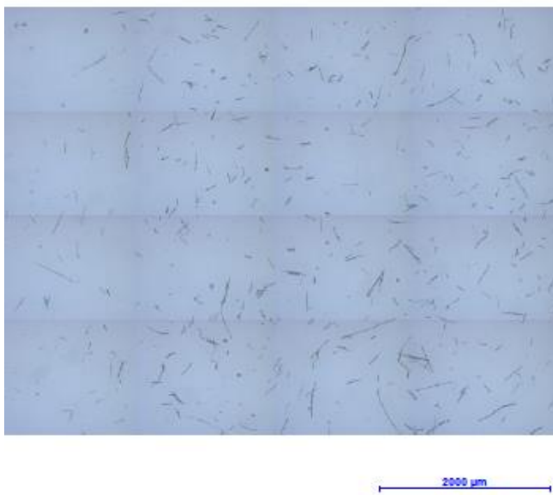
Figura VII.1 – Filtro membrana com fibras Rockforce® MS603 – Análise ao microscópio ótico com análise de imagem.
