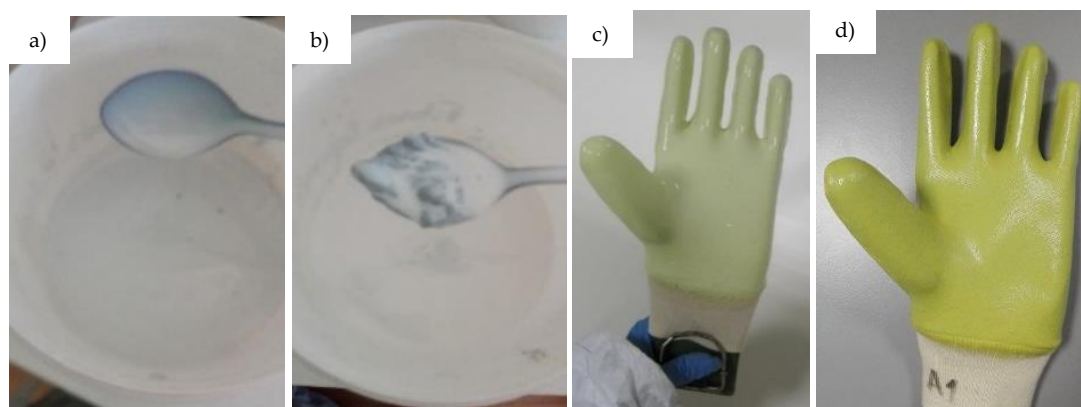
Figura 4.8 – a) Amostra A_{P1} , 31 dias após a sua preparação; b) Amostra A_{CP1} , 4 dias após a sua preparação; c) Luva obtida após dipping na amostra A_{P1} ; d) Amostra AA_{CP1} após processo de vulcanização.
