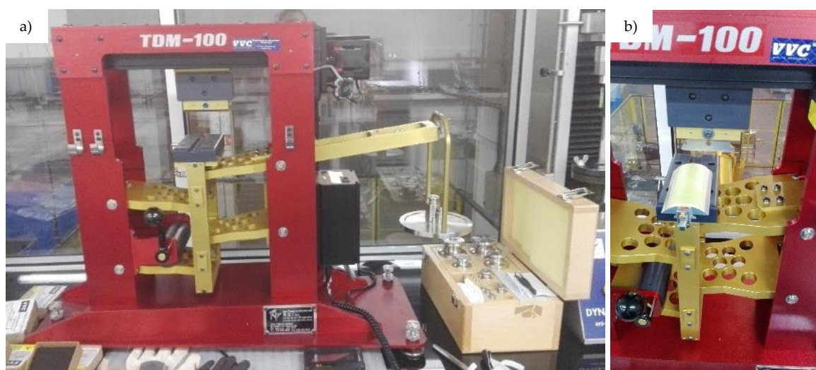
Figura 3.15– a) Equipamento para realização do teste TDM-100 ; b) Detalhe do suporte da amostra.
