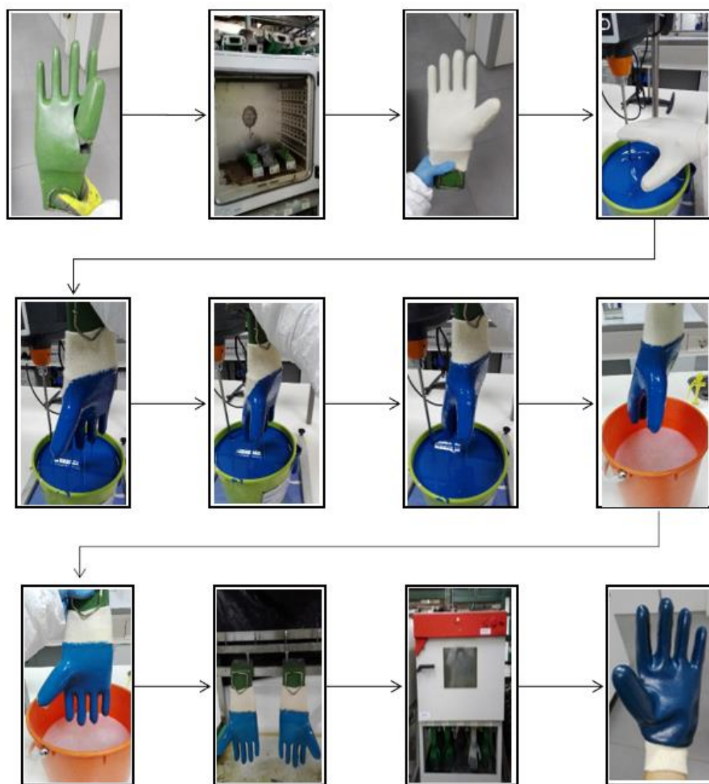
Figura 3.14 - Esquema ilustrativo do processo de dipping realizado no laboratório da Ansell Portugal.
