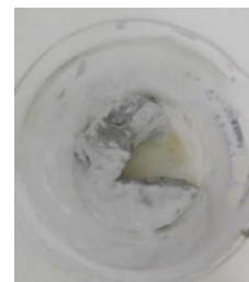
Figura 4.4 - Resultado obtido após utilização do banho de ultrassons na dispersão das fibras Rockforce® MS603.
