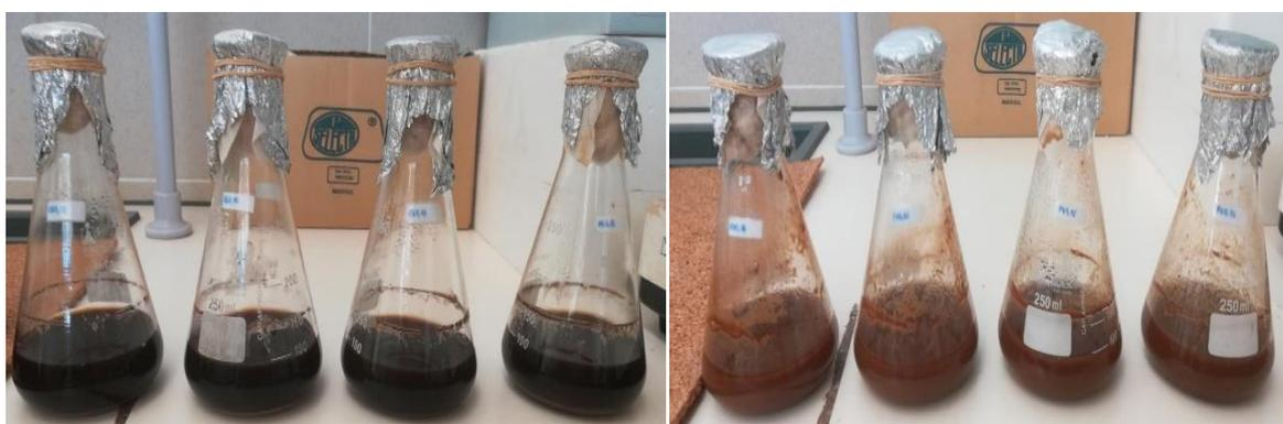
Figura 4.25 - Amostragem dos ensaios de SSF da pasta de casca de eucalipto e da pasta de fibra mista virgem, às 72 h; consistência (9%); carga enzimática (15 e 10 FPU/g<sub>HC</sub>).
