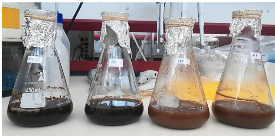
Figura 4.24 - Amostragem dos ensaios de SSF da pasta de casca de eucalipto e da pasta de fibra mista virgem, às 72 h; consistência (6%); carga enzimática (15 e 10 FPU/g<sub>HC</sub>).
