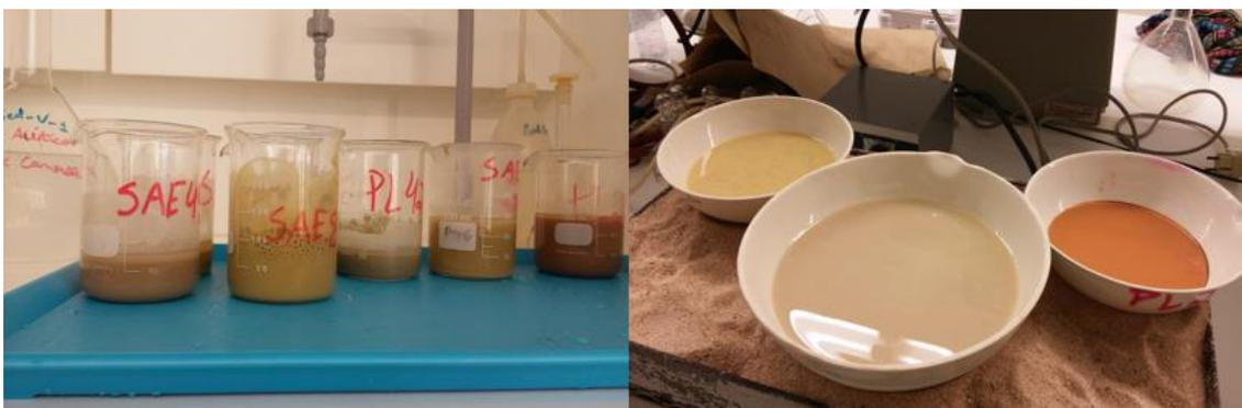
Figura 3.1. Processo de descarbonatação com ácido acético a 15 % das amostras (à esquerda) e processo de secagem no banho de areia (à direita).
