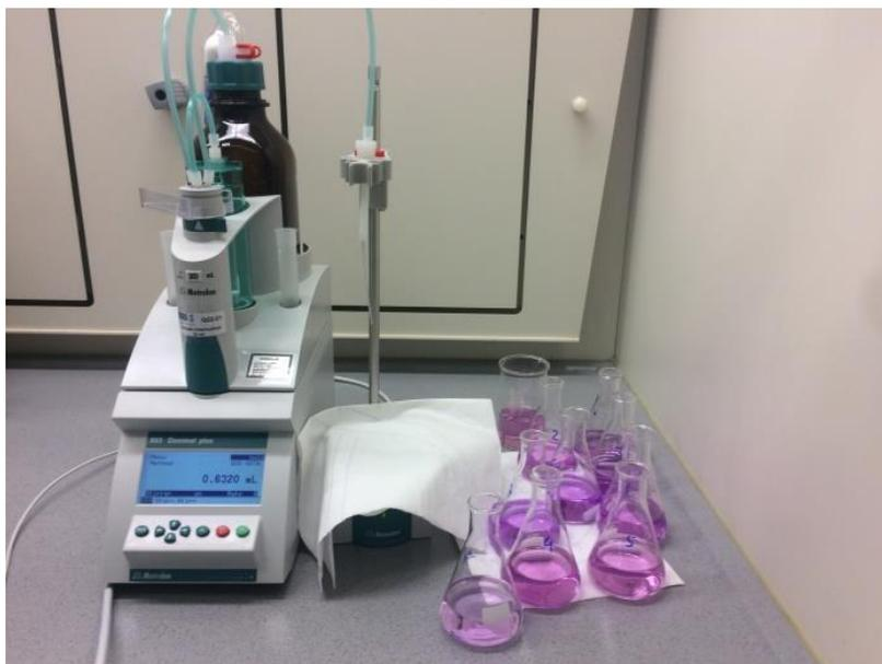
**Figura 18 - Método de titulometria para a determinação da dureza total**
