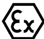
Figura 6. Símbolo utilizado para marcar equipamentos antideflagrantes.
