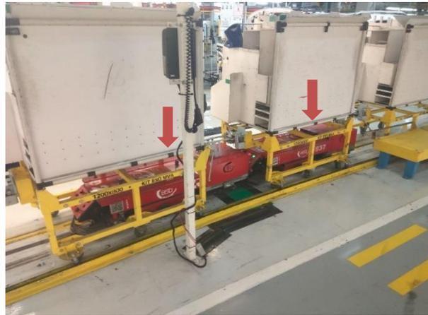
**Figura 5.2.** Paragem simultânea de 2 AGVs, num posto de carregamento.
