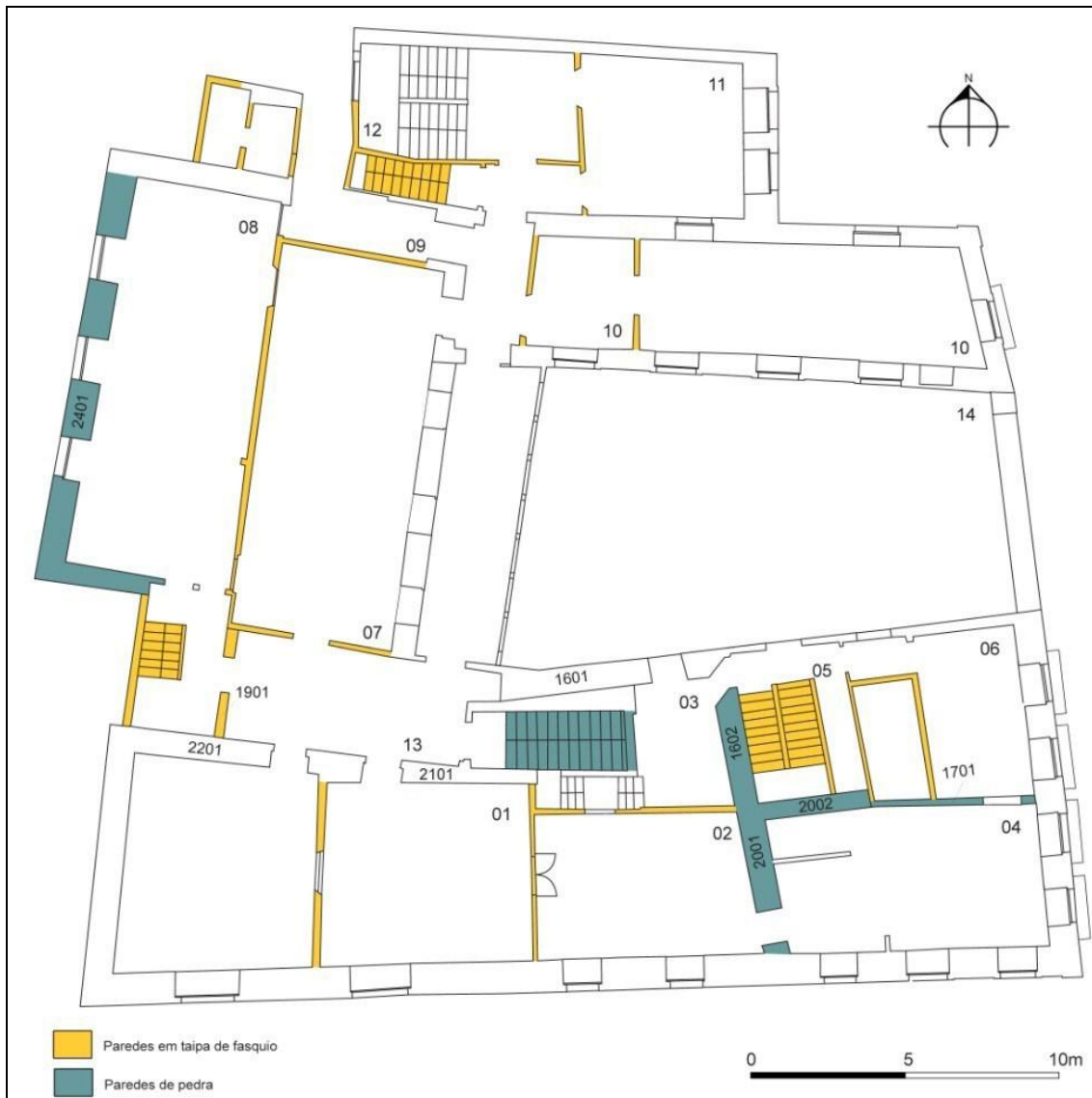
Fig.359 – Planta das demolições no piso 1 408 .
