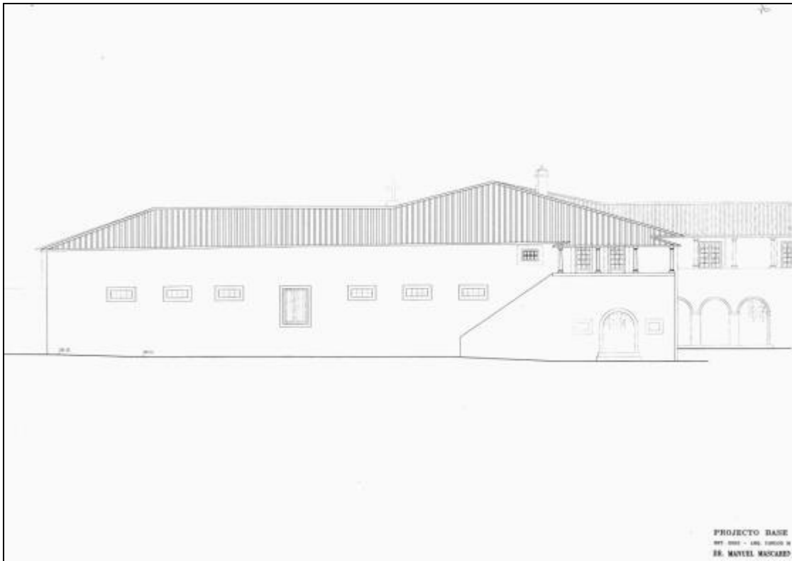
Fig.669 – Projeto Base, setembro 2003 – Arquiteto Carlos Maria de Azeredo. Dr. Manuel Mascarenhas Gaivão - Quinta da Azenha – Cambres – Lamego 725 . Varanda alpendrada com colunas; lance de escadaria exterior.
