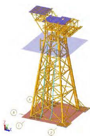
Figura 4.7 – Modelo de cálculo da estrutura concebido no programa SACS
