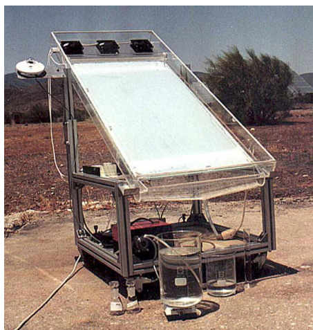
Figura 1.9 Reator fotocatalítico de fluxo laminar [151].
