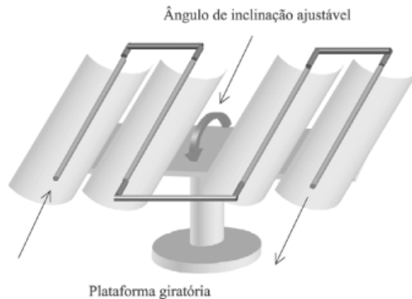
Figura 1.8 Representação esquemática do reator parabólico concentrador de energia solar [150].
