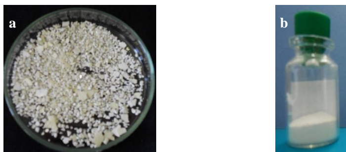
Figura 2.3 Catalisador de TiO 2 B sintetizado pelo método sol-gel com catálise ácida.
