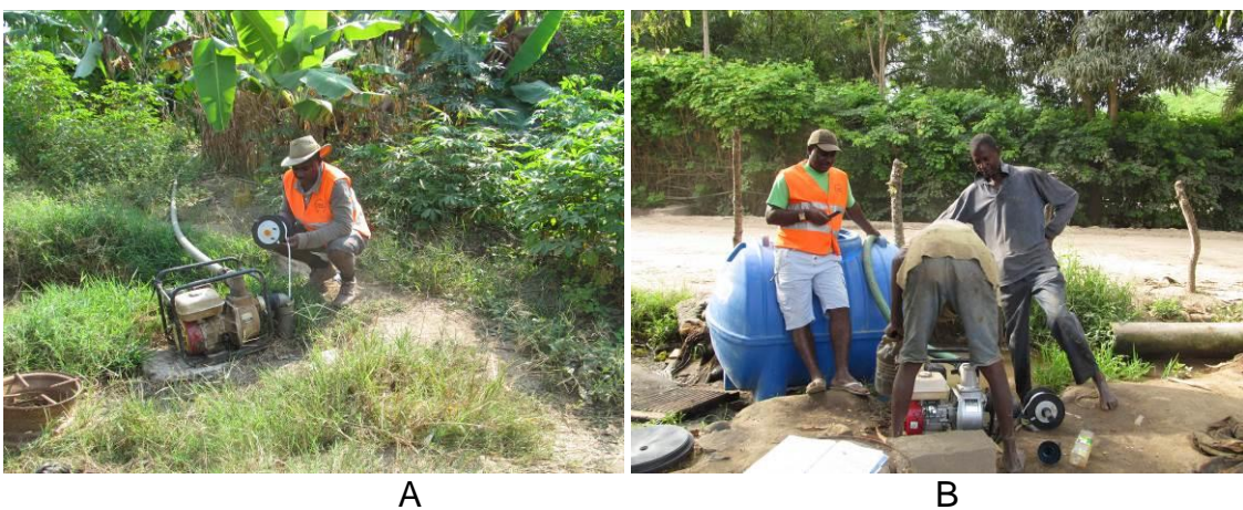
Figura 3. 4. Ilustração de alguns momentos e procedimentos da realização de ensaios hidráulicos do tipo pumping test.
