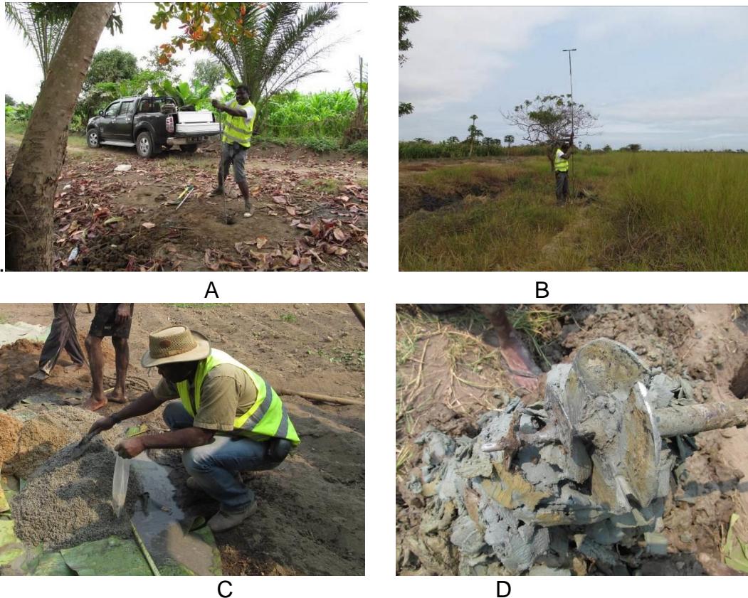
Figura 3. 3. Ilustração de alguns momentos da execução de furos curtos e para amostragem de sedimentos (A e B) e sondagens longas (C e D) na área de estudo.
