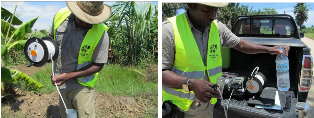
Figura 6. 2. Aspectos da medição de níveis piezométricos utilizando o Geotechnical instruments (2011).
