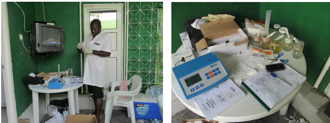
Figura 7. 3. Equipamento e momentos da análise química dos vários parâmetros utilizando o fotómetro de bancada Multiparâmetros de marca Hanna de modelo HI83200.
