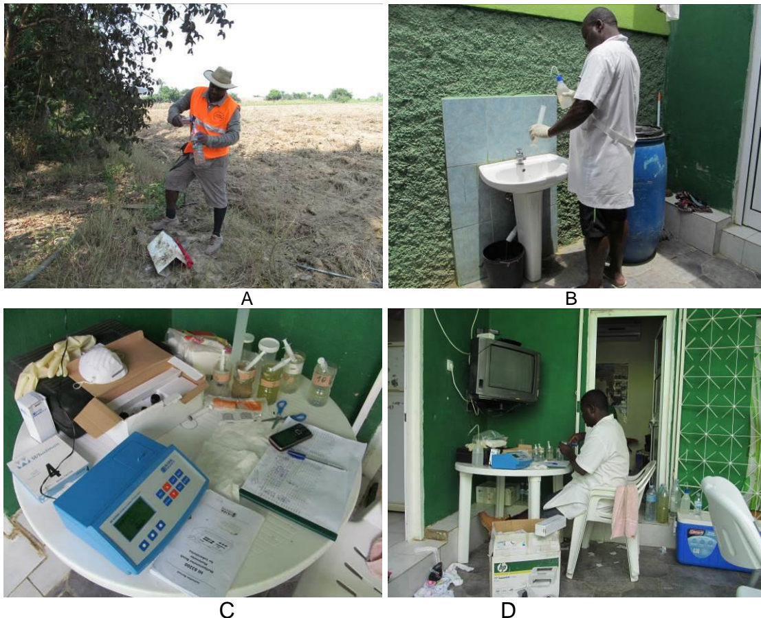
Figura 3. 7. Vista parcial dos momentos de análise química de água. A - amostragem de água ao longo da área de estudo; B - preparação de meios de trabalho; C – Montagem de laboratório móvel no domicílio e respectivas análises químicas (B e C).
