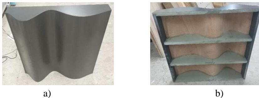
Figura 7.7 - Provete otimizado, para incidência normal, apenas para uma banda de frequência de oitava centrada em f=1000 Hz. a) Superfície frontal; b) Tardoz.
