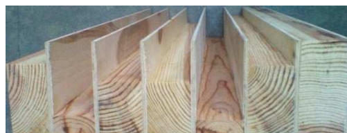
Figura 4.21 – Difusor QRD em madeira maciça com guias-de-onda [24].
