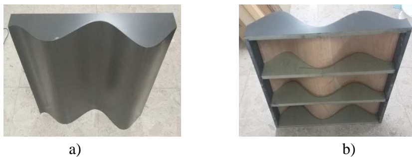
Figura 7.9 - Provete otimizado, para incidência normal, maximizando a média ponderada para 9 bandas de terço de oitava nas altas frequências, de 800 Hz aos 5000 Hz. a) Superfície frontal; b) Tardoz.
