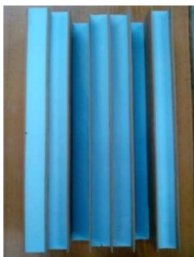
Figura 4.23 – Difusor QRD em XPS com guias-de-onda [24].
