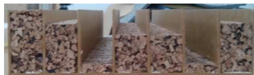
Figura 4.22 – Difusor QRD em aglomerado de cortiça com guias-de-onda [24].
