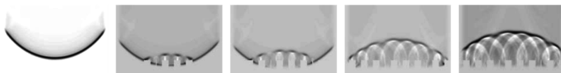
Figura 2.21 – Reflexão de uma onda cilíndrica numa superfície híbrida – simulação numérica FDTD [1].
