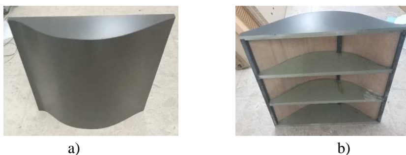
Figura 7.8 - Provete otimizado, para incidência normal, maximizando a média aritmética para 9 bandas de terço de oitava nas médias frequências, de 400 Hz aos 2500 Hz. a) Superfície frontal; b) Tardoz.
