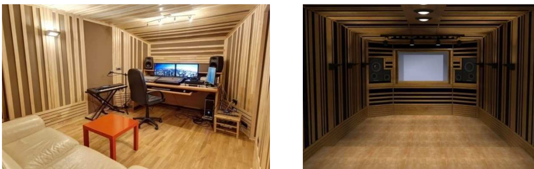
Figura 2.41 – Exemplos de estúdios de gravação onde são utilizadas superfícies híbridas (as partes escuras são absorventes sonoros).
