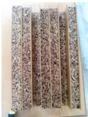
Figura 4.22 – Difusor QRD em aglomerado de cortiça com guias-de-onda [24].
