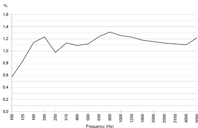
Figura 4.4 - Curva de absorção sonora da solução de revestimento utilizada na sala semi-aneecóica do DEC/FCTUC [45].
