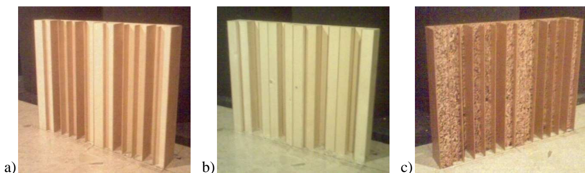
Figura 4.25 – Dois difusores QRD (período p = 2 ): a) Em madeira maciça com guias-de-onda; b) Em madeira maciça sem guias-de-onda; c) Em aglomerado de cortiça com guias-de-onda [24].
