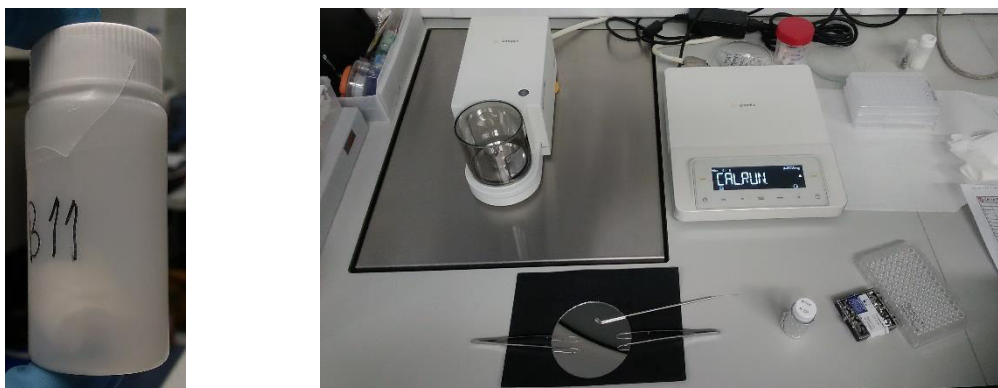
Figura 2.3 - Colagénio extraído da amostra RB11 (à esquerda) e balança de precisão digital onde é efetuada a respetiva pesagem (à direita).
