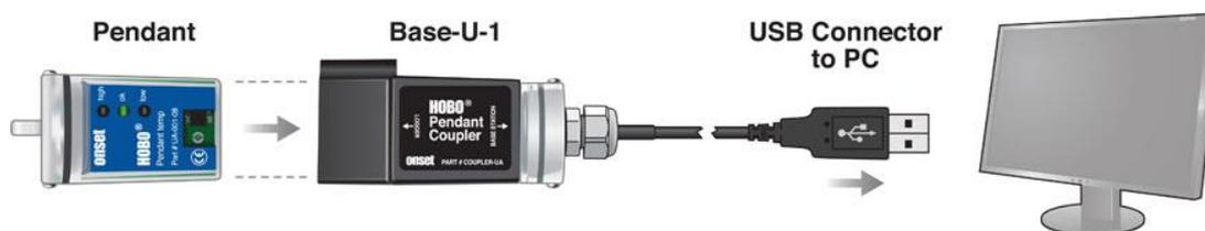
Figura 27 - Interface ótica para transferência de dados.
