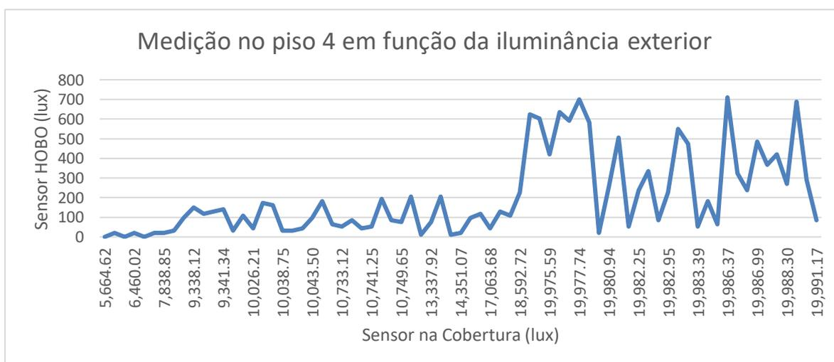
Figura 15 - Medição no piso 4 da FFUC em função da iluminância exterior.
