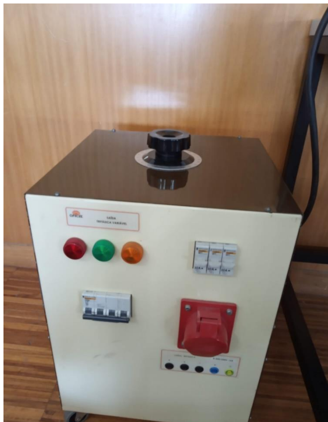
Fig. G. 9 – Auto-transformador.
