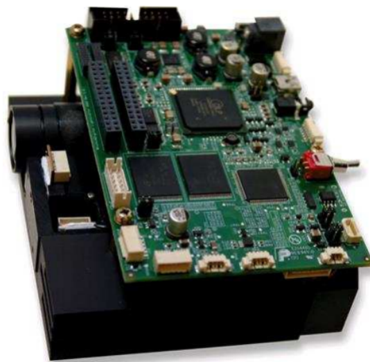
Figura 4.2: Representação do DLP LightCrafter 4500 EVM. Retirado de [85].
