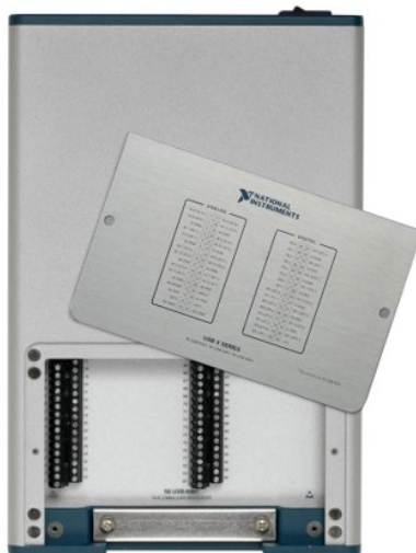
Figura 4.6: Sistema de aquisição digital utilizado no protótipo da SPC.
