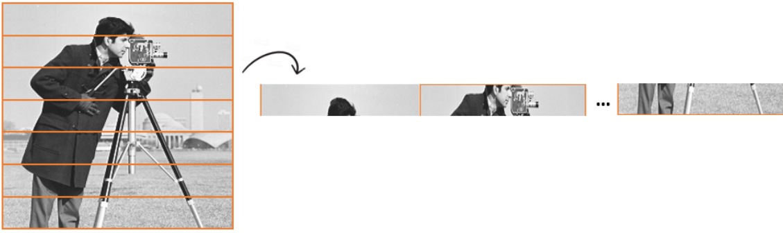
Figura 3.2: Esquema representativo da transformação da imagem num vetor unidimensional.
