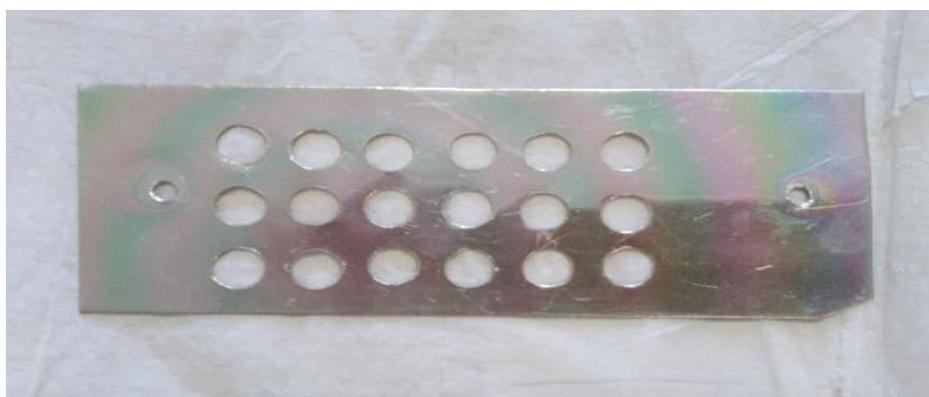
Figura 2.1. Porta-substratos utilizado nas deposições das lamelas de vidro.
