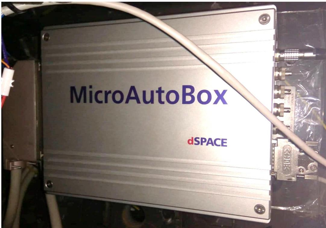
Fig. A.9 - Plataforma de controlo em tempo real Microautobox II que se encontra colocada atrás do porta-luvas.
