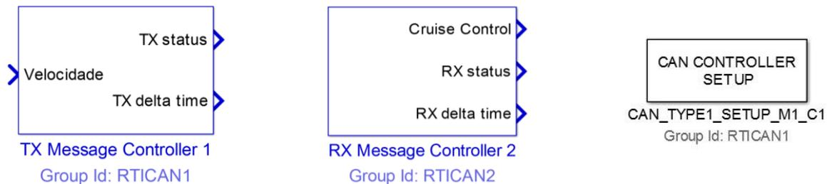
Fig. 4.11 - Exemplos dos blocos de transmissão, recepção e configuração geral, respetivamente, utilizados no protocolo de comunicação CAN inserido no modelo de controlo.
