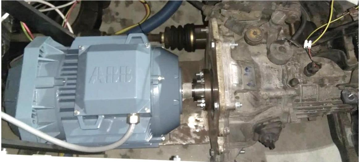
Fig. A.8 - Motor SynRM acoplado à caixa de velocidades do veículo.
