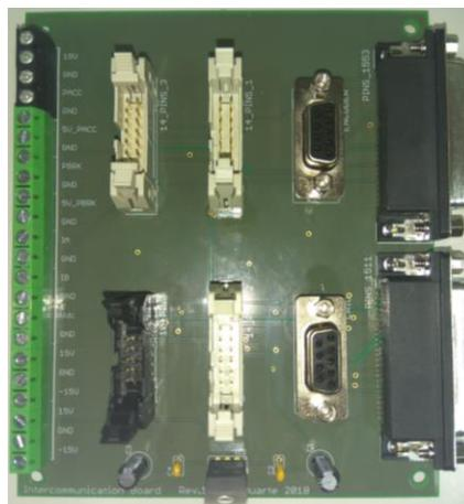
Fig. 5.3 - Placa de Distribuição de Sinais provenientes da Microautobox II.
