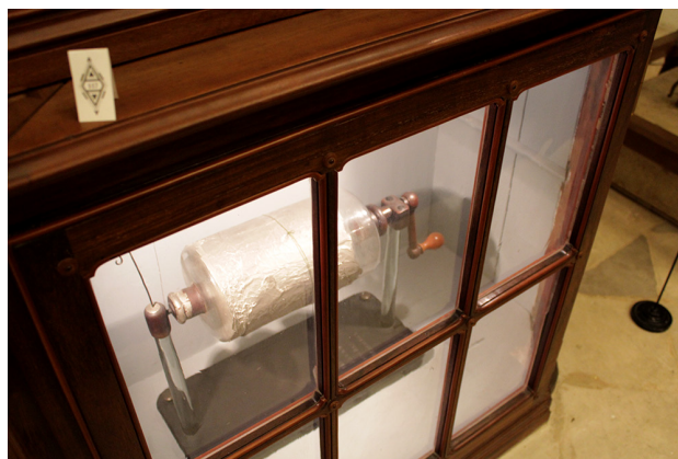
Fig. X Máquina Eléctrica de Nairne com apoios de madeira. Nos instrumentos que estão dentro de armários e não têm legenda o marcador podia ser colocado utilizado vinil no vidro.
