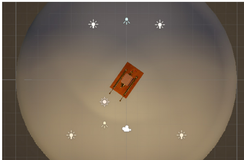
Fig.X2 - Iluminação com luzes de ponto em quatro posições. As dianteiras (#ffe0a9) têm maior intensidade e ajudam a realçar os detalhes do instrumento enquanto as traseiras (#fffaee) permitem equilibrar o contraste da cena. À esquerda vemos o resultado final do processo de iluminação da cena.
