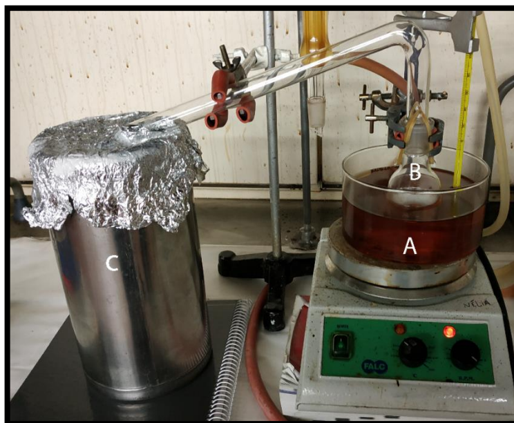
Figura 2.1 - Configuração utilizada para a substituição isotópica do benzimidazol. A - Banho termostático (80 °C). B – Balão de fundo redondo com benzimidazol e metanol monodeuterado incorporados. C – Balão de fundo redondo submerso num banho de azoto líquido ( T= 77 K), onde o metanol foi posteriormente retido.
