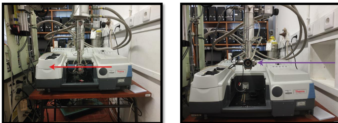
Figura 2.3 - Sistema de isolamento em matrizes utilizado para a aquisição do espectro de infravermelho (esquerda) e para a irradiação da amostra (direita). As setas a vermelho e violeta simbolizam o feixe do espectrofotómetro, utilizado para a aquisição do espectro de infravermelho, e o feixe do sistemas LASER:OPO, utilizado para a irradiação da amostra, respetivamente.
