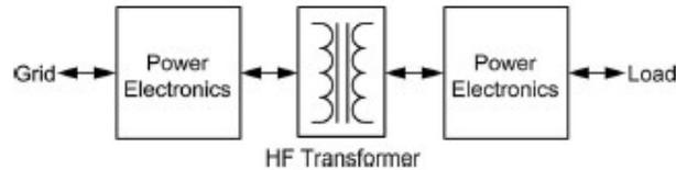
**Figura 1-1** Estrutura Básica de um Transformador de Estado Sólido [4]
