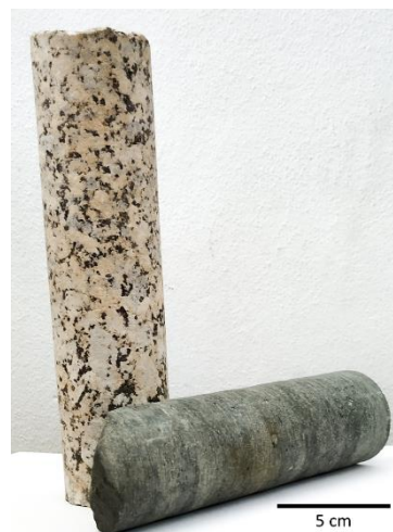
Figura 9 - Exemplos de tarolos de sondagem [foto da autora].
