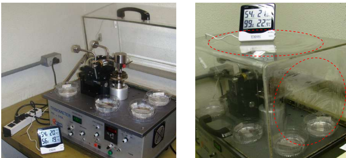
Figura A.5 - Fotografia da câmara de teste do tribômetro antes e depois da climatização, utilizando solução saturada de sulfato de potássio. Em destaque, película de água (orvalho) nas paredes da câmara em função do resfriamento do vapor d'água presente no interior da câmara.
