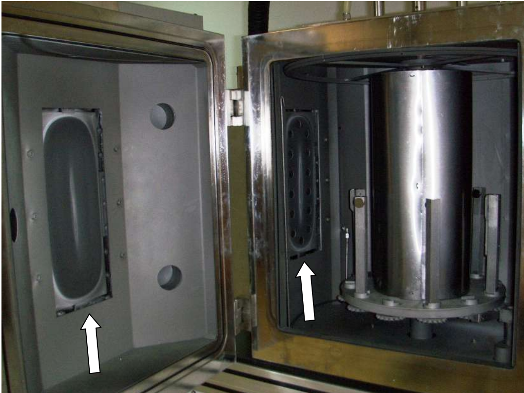
Figura 6.2 - Fotografia da câmara de deposição. Em destaque, a disposição dos alvos dentro da câmara num ângulo de 90°.
