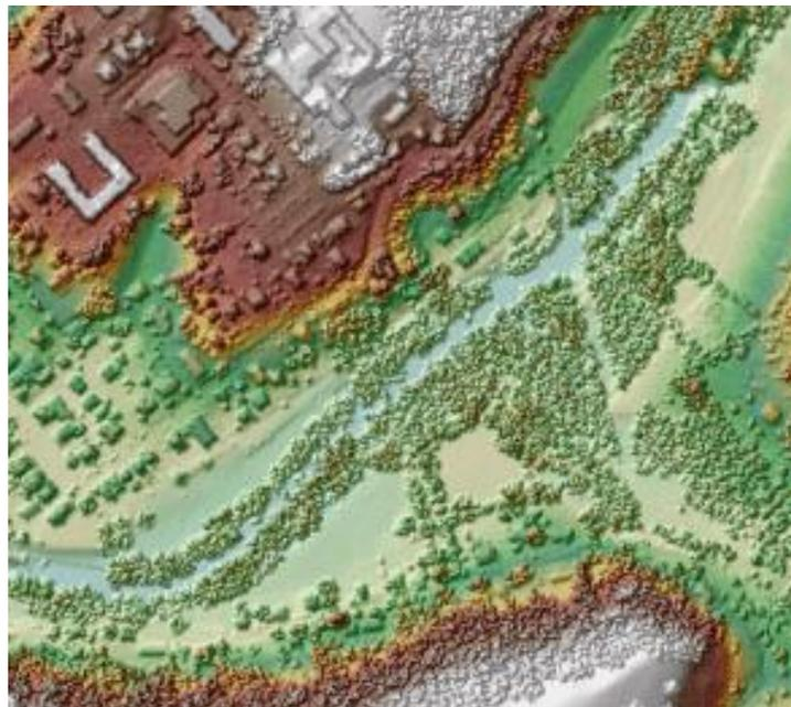
Figura 4: Modelo Digital de Superfície obtido a partir de dados LiDAR. (Fonte: ESRI).
