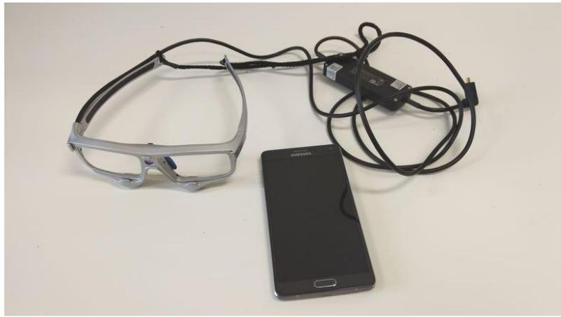
**Figura 11: Sistema de Eye Tracking Glasses utilizado para a recolha de dados provenientes dos movimentos dos olhos, composto pelos óculos e por um smartphone destinado ao armazenamento dos dados (Laboratório Robocorp – IIA – IPC).**
