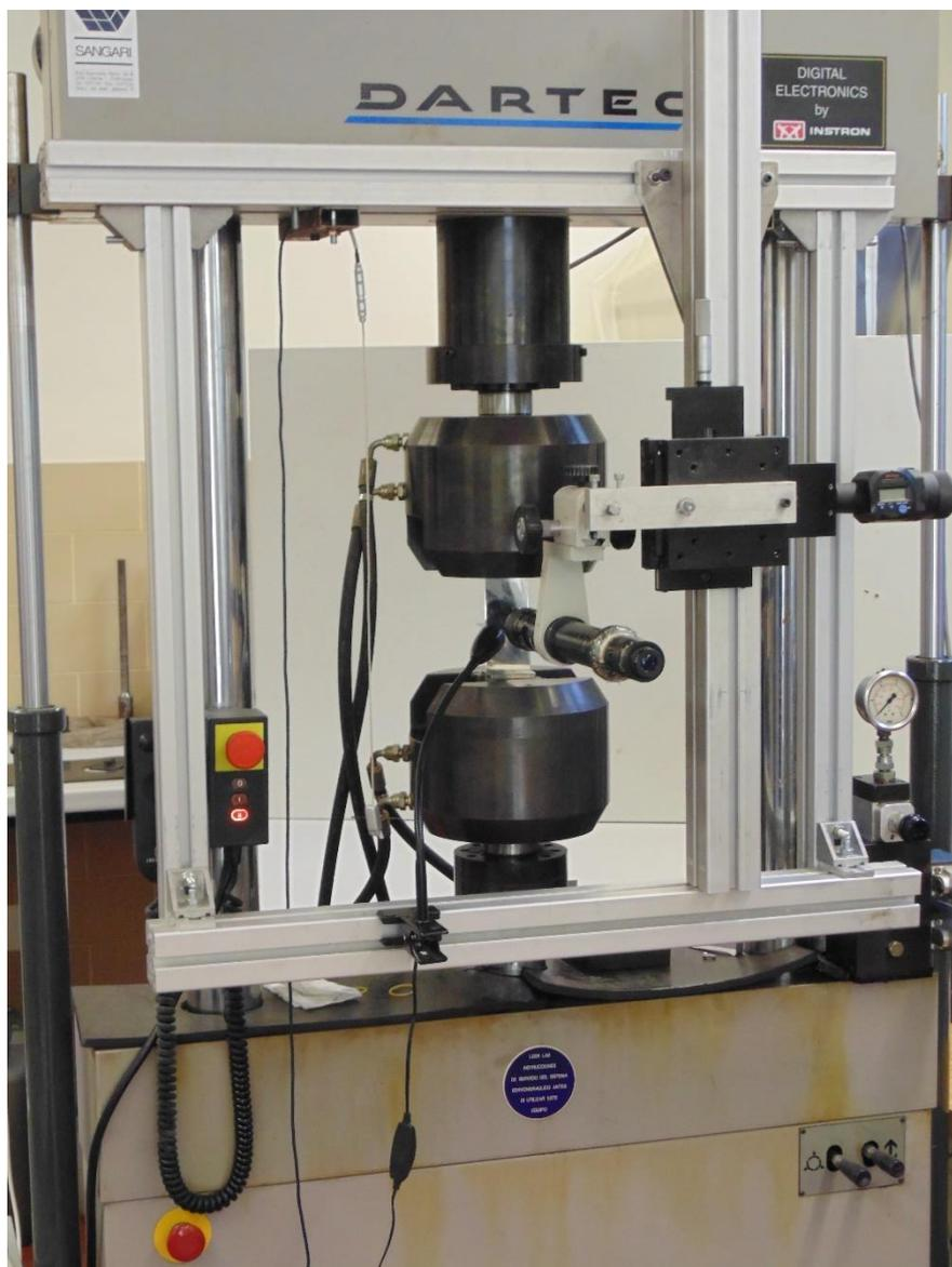
Figura 3.7. Sistema ótico de medição de comprimento de fenda.
