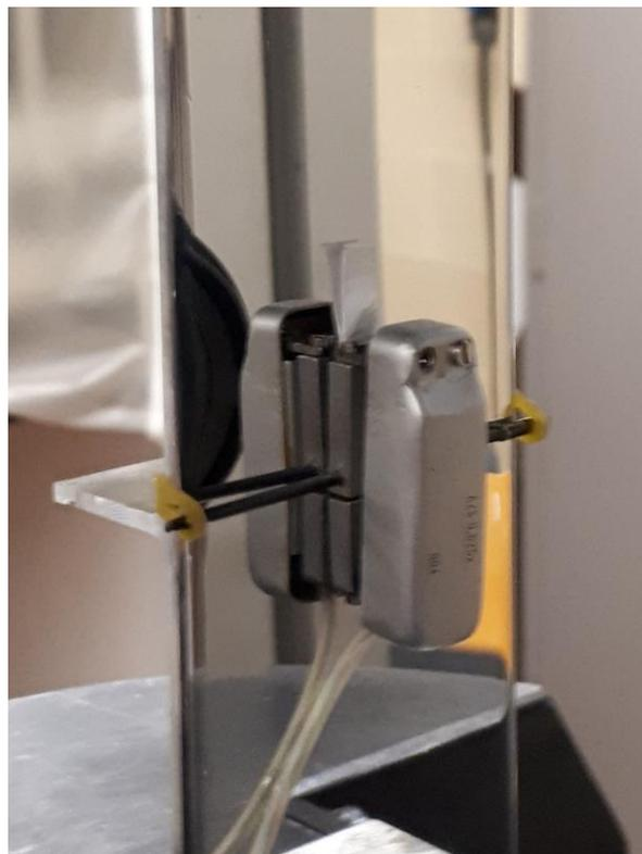
**Figura 3.9.** Posicionamento do extensómetro no provete.
