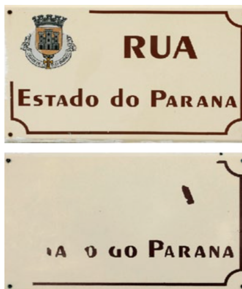
Figura 4 – Toponímia de Castelo Branco executada em PVC com a informação disposta em vinil recortado (© Veríssimo, 2008).
